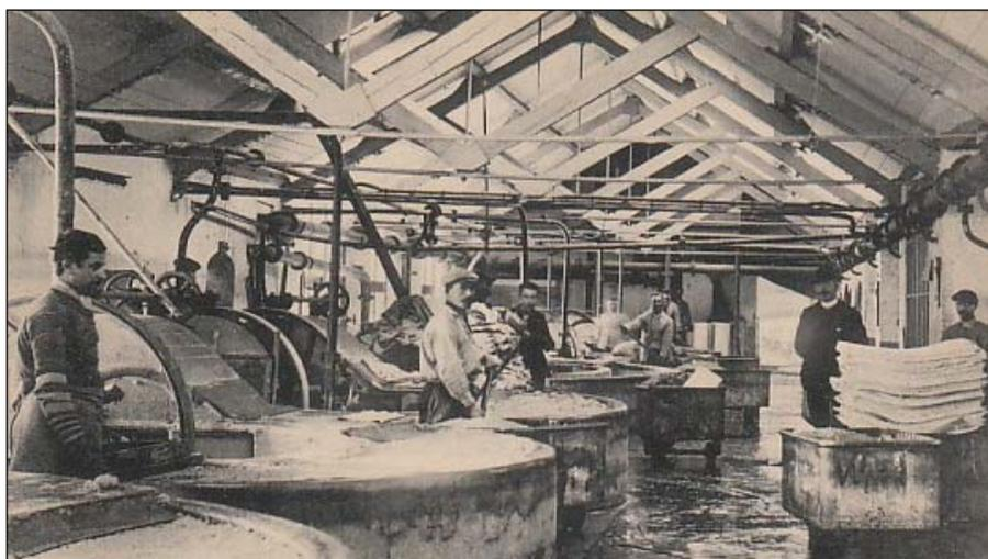
Figure 7 : Les cylindres-broyeurs des pâtes (début XX<sup>e</sup>)
