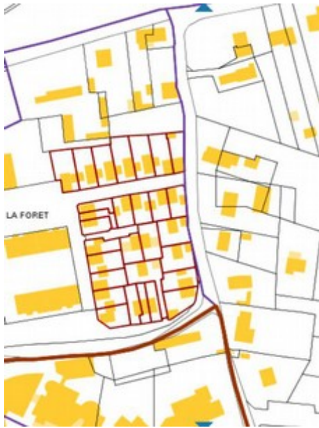
ZAC des Gués de Veigné (37) Aménageur : Société d'Équipement de Touraine (SET) Promoteur : Sully Promotion Veigné (37) : 29 parcelles de 110 à 347 m 2 , moyenne de 174m 2 Dimensions : 62m*78m (0,48ha) pour une densité de 44 logts/h
